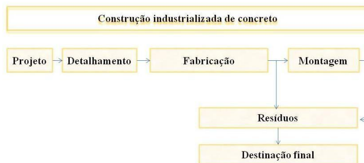
Figura 3 - Fluxograma da linha de produção da construção industrializada
