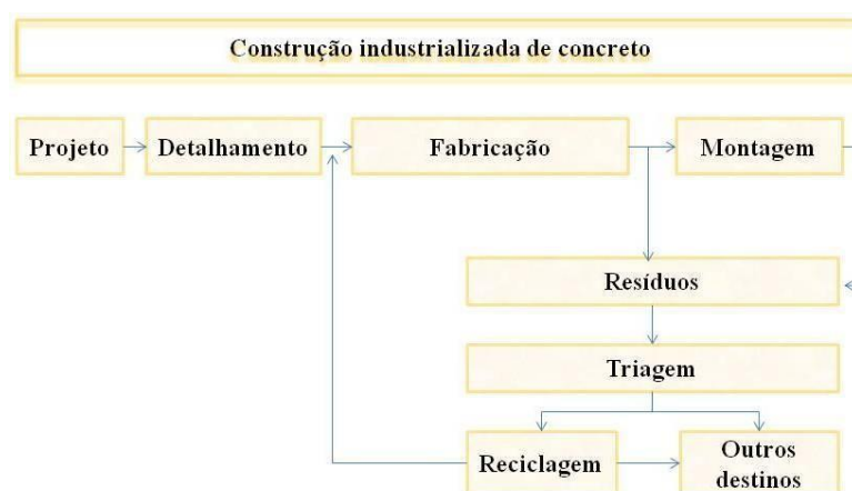
Figura 4 - Fluxograma da linha de produção da construção industrializada com implantação do PGRS
