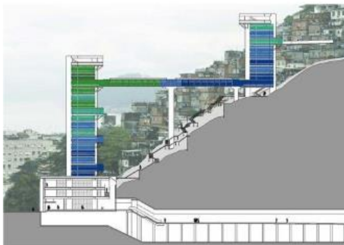
Figura 5- Corte do projeto do elevador do Cantagalo
