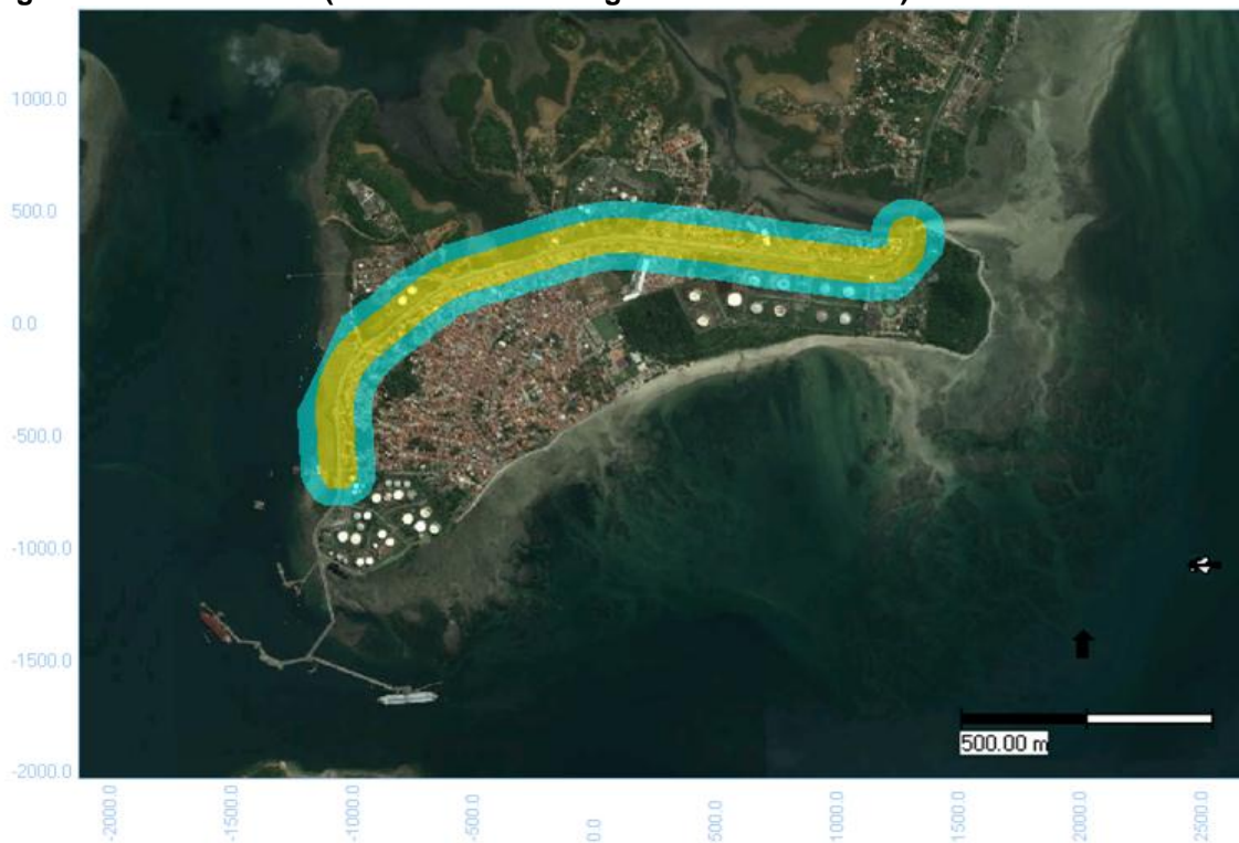
Figura 29: Evento EI-05 (BLEVE e bola de fogo nos dutos de GLP)
