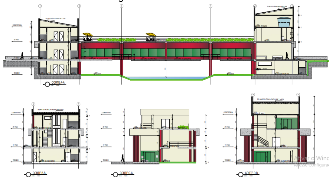
Figura 54. Cortes do Pórtico
