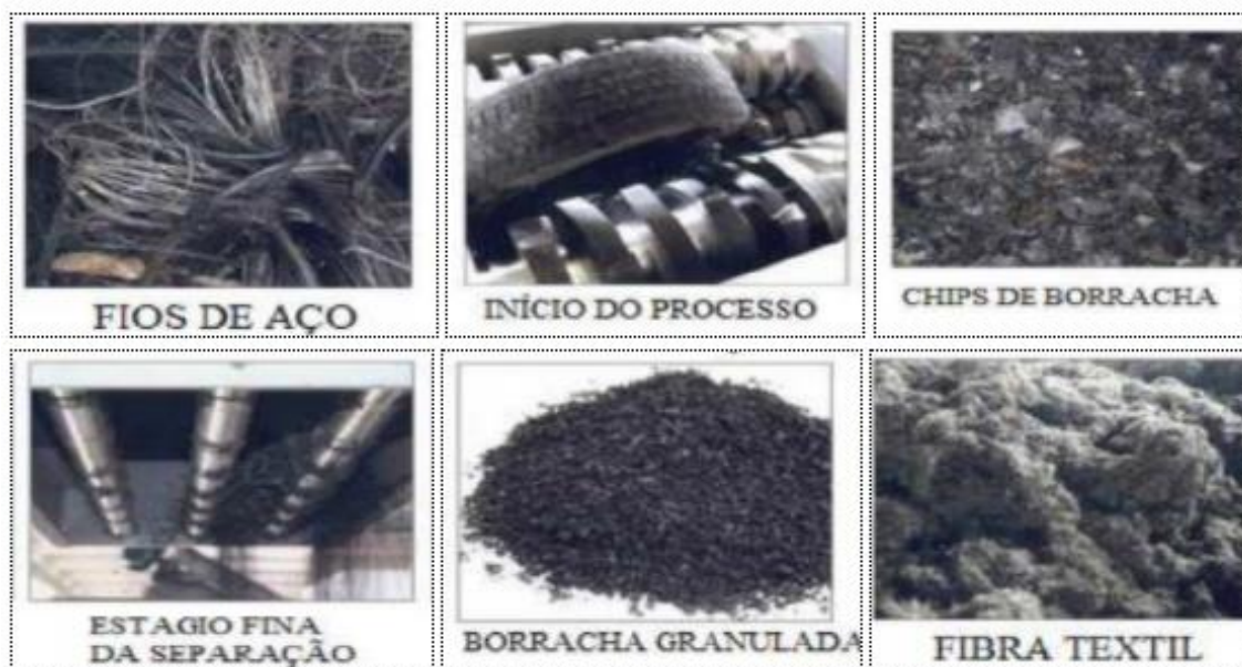
Figura 1: Processo de separação dos materiais constituintes do pneu de borracha
