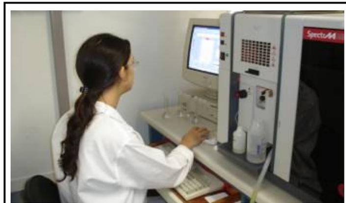
**Figura 06.** Leitura das amostras solubilizadas de folhas e rizóforos em espectrômetro de absorção atômica com chama.
