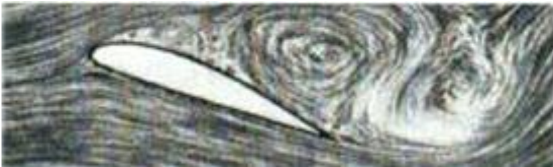
Figura 16: Escoamento em torno do perfil de uma pá de rotor com “stall control”
