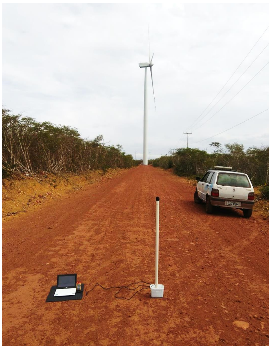
Figura 36: Teste de medição de ruído no Complexo Eólico Serra Azul
