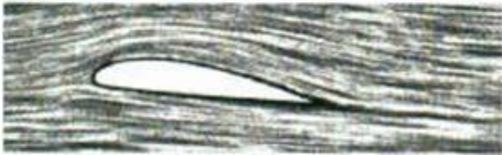
Figura 15: Escoamento em torno do perfil de uma pá de rotor não controlado
