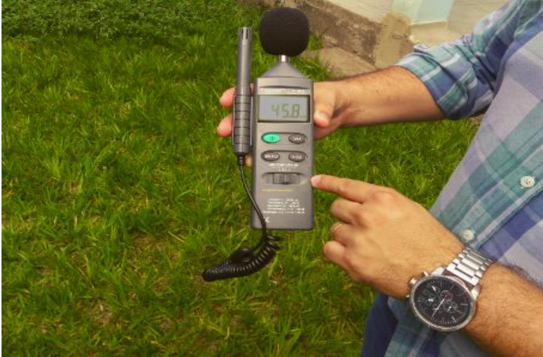
Figura 34: Medidor multifunção. Teste de medição de ruído
