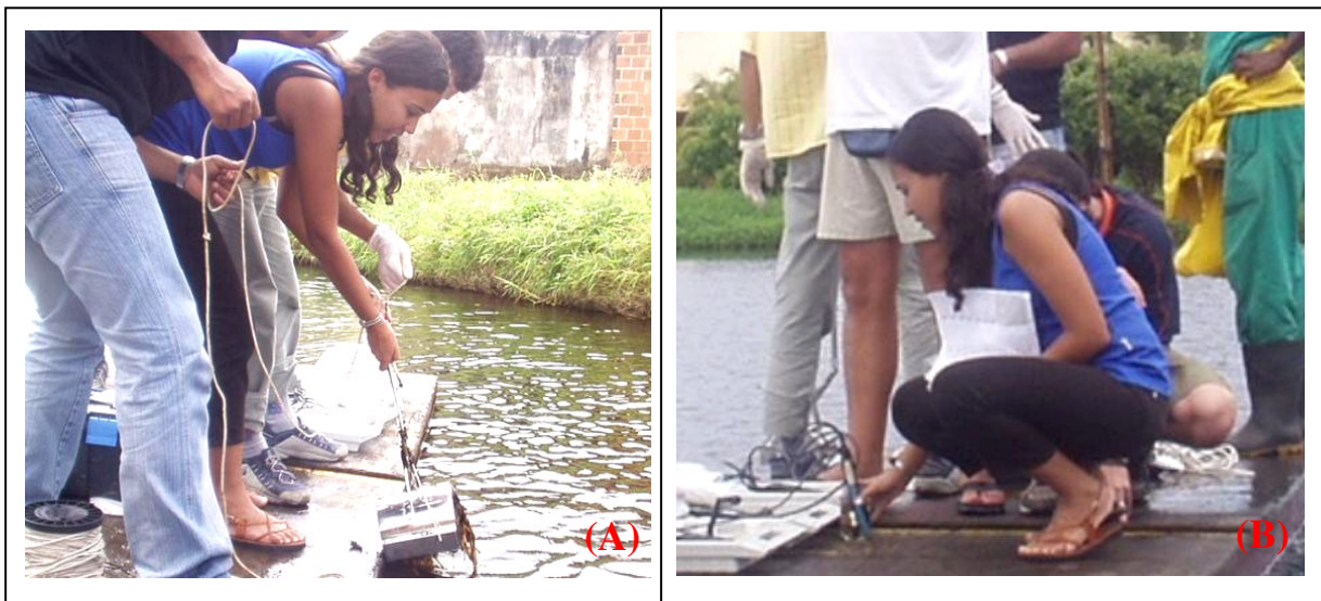
FIGURA 2. Coleta na lagoa de Praia do Flamengo: (A) coleta do sedimento com auxílio da draga; (B) análise físico-química da água.
