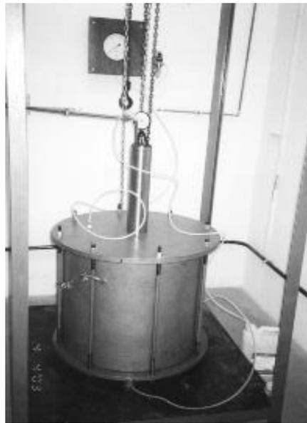
Figura 3- Vista do consolidômetro construído para a realização dos ensaios de compressão confinada.
