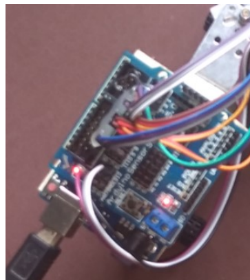
Figura 22 – conexões feitas no sensor shield fonte: autor
