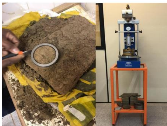
Figura 2 - Moldagem do anel e prensa para ensaio de pressão de expansão
